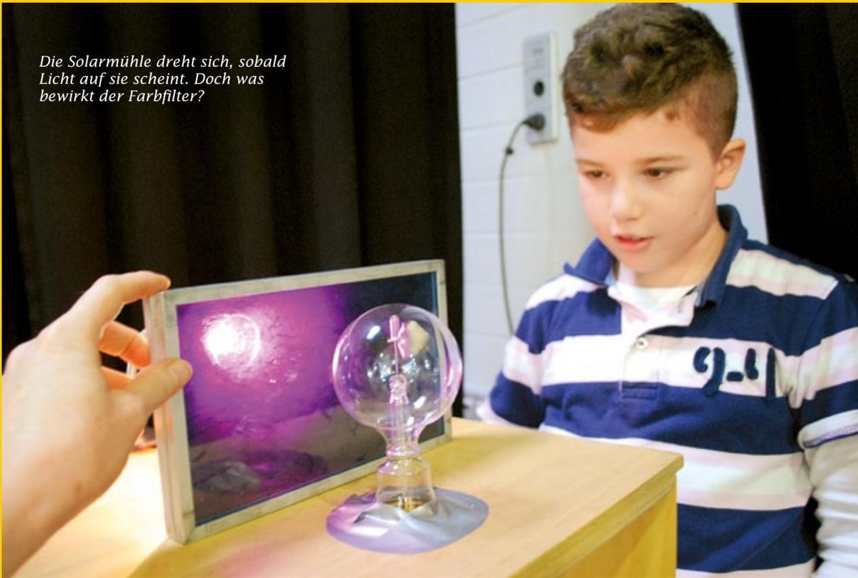
**DAS EXPERIMENT HEISST SOLARMÜHLE:** links eine Lampe, rechts ein Glaskolben mit eingebautem Flügelrad. Es dreht sich, sobald Licht darauf scheint. Der Junge staunt. Jetzt hält er einen Farbfilter dazwischen. Er experimentiert. Dreht sich die Mühle bei farbigem Licht anders? Der Junge beobachtet mit Spannung, was passiert.
